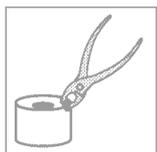
Muffeln nach dem Guss an einem geschützten und gekennzeichneten Platz an der Luft auf Handwärme abkühlen lassen, **nicht in Wasser abschrecken!**
